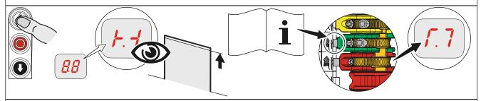
3. Остановить ворота в 5 см перед конечным положением ЗАКР. и настроить предварительный концевой выключатель S5
