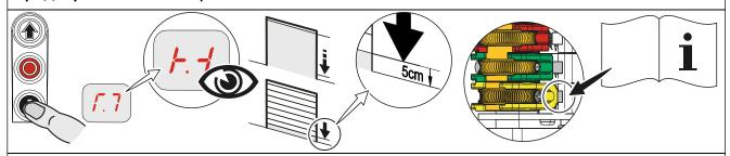
4. Привести ворота в движение до конечного положения ЗАКР. и настроить концевой выключатель S4 ЗАКР.
